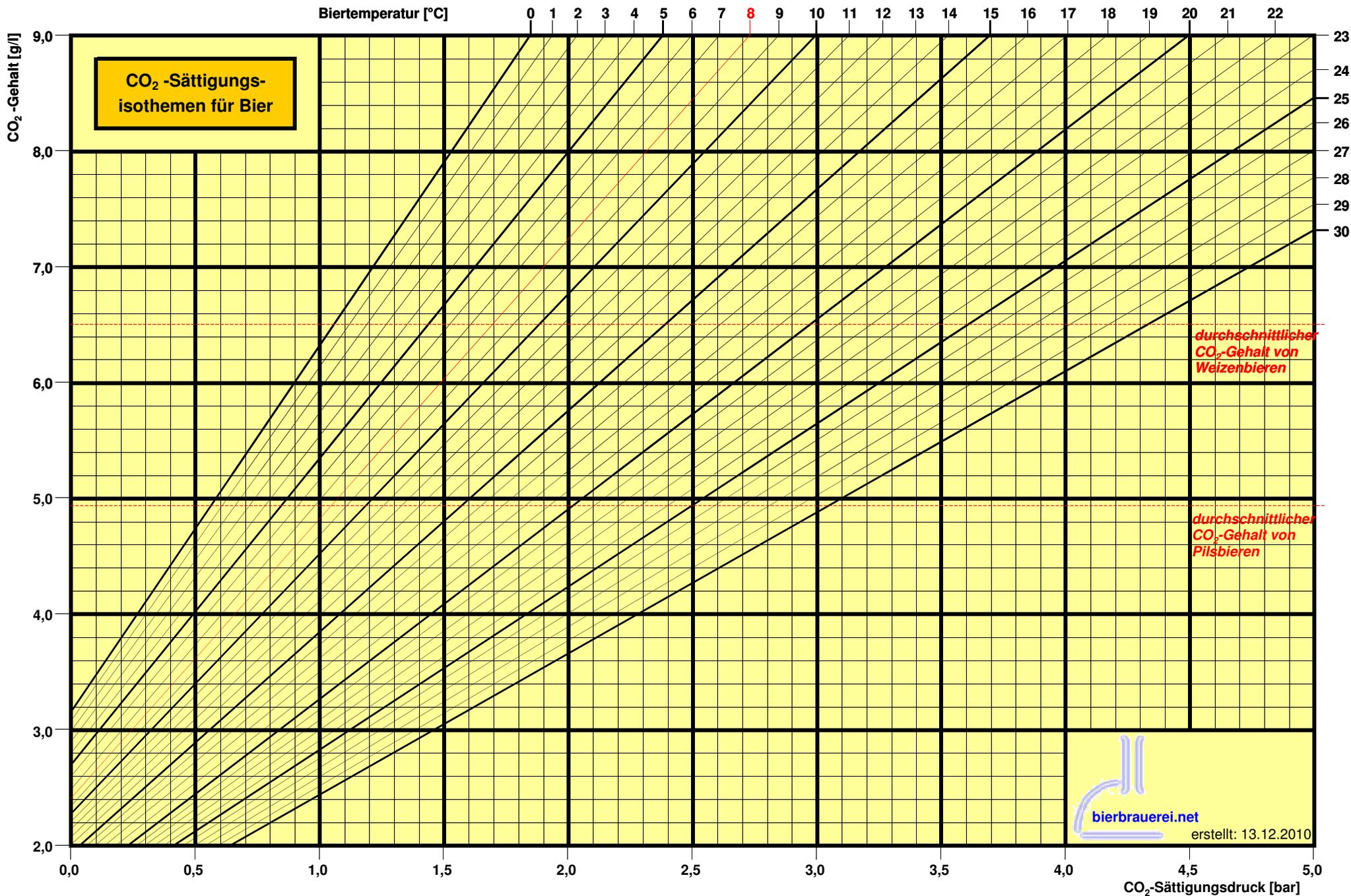
**Aus dieser Tabelle lässt sich der benötigte Druck ermitteln, bei dem bei definiertem CO<sub>2</sub>-Gehalt und Temperatur das CO<sub>2</sub> im Bier gehalten wird.**
